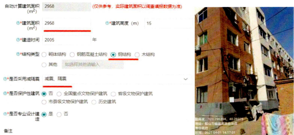
图3 某房屋结构类型与照片不符且多项存疑
